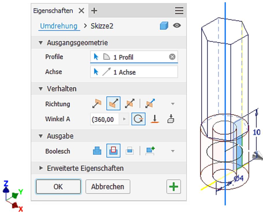
Damit ist der Zapfen des Distanzstücks nun fertig gedreht und kann im nächsten Schritt ein Außengewinde erhalten.
