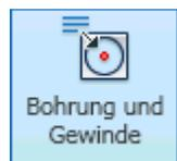
Für Bohrungen besteht die Möglichkeit, sogenannte **Bohrungs-/Gewindeinfo** zu verwenden. In Form einer vereinfachten Bemaßung erscheinen dann sämtliche Angaben zur Bohrungskonfiguration. Die Darstellung ist jedoch nicht ganz normgerecht. Mit etwas Editier-Aufwand kann man die Beschriftung normgerecht gestalten (DIN 6780 oder [1] S.4.6 unten).
