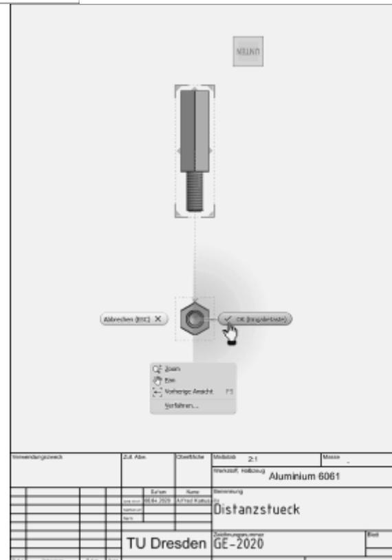
Das Schriftfeld wurde nach dem Platzieren der Erstsicht automatisch mit Informationen aus dem Bauteil belegt (Variablen aus *iProperties* - fehlenden Masse-Wert erneut berechnen durch "Aktualisieren" in physikalischen Eigenschaften):
