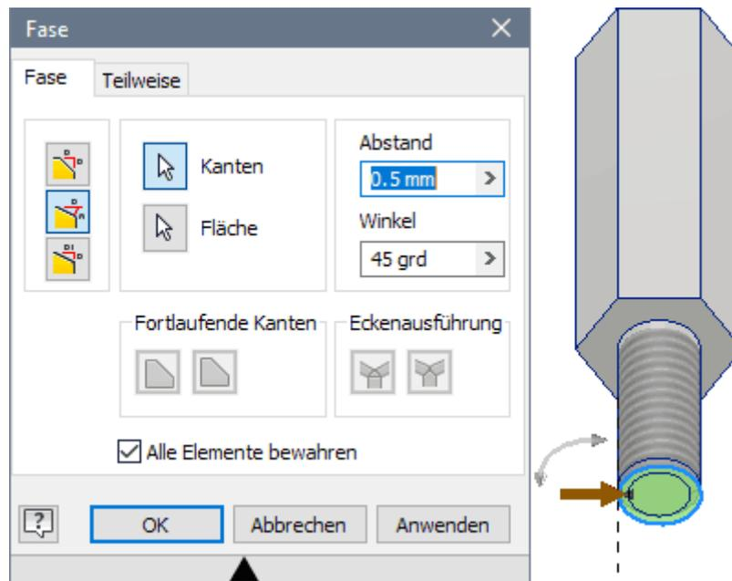
Im Normalfall ist die Verwendung des Winkels sinnvoll, weil dann der Wert des Winkelmaßes auch in der Zeichnung zur Verfügung steht. Außerdem kann man bei Bedarf diesen Winkel nachträglich problemlos ändern.
