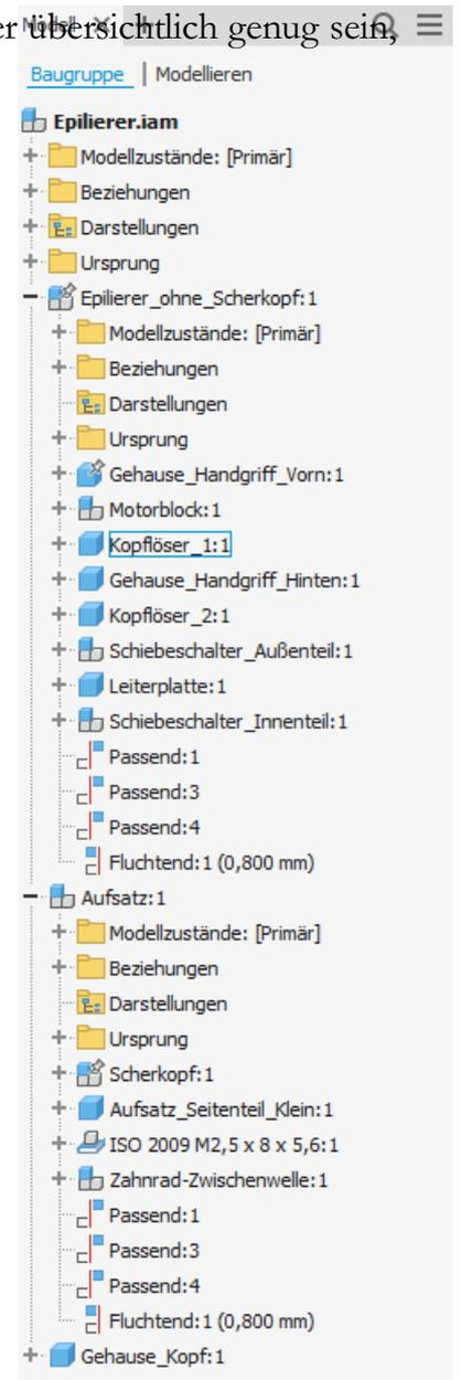
Die blauen Gehäuseteile benötigen sehr viel Speicher und wurden nicht mit einer der bisher vorgestellten Konstruktionsmethoden von Grund auf neu erstellt. Mit **Rechtsklick Kontextmenü > Öffnen** (Grafikbereich oder Modellbrowser) öffnen wir eines der Gehäuseteile und versuchen anhand der Featurehistorie den Konstruktionsprozess nachzuvollziehen.
