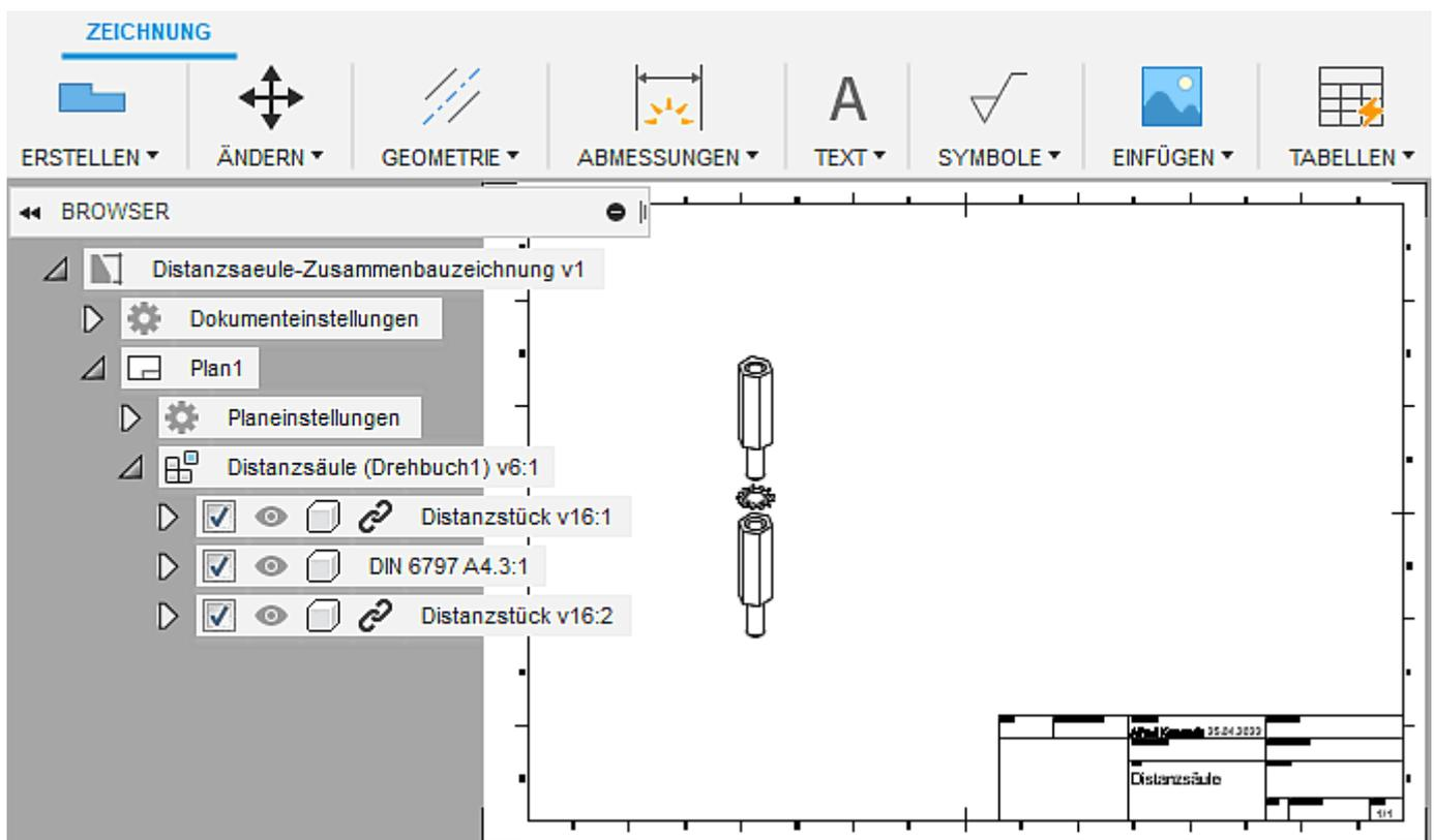
Die Einzelteil-Komponenten sollen in der Explosionsdarstellung jeweils eine Positionsnummer <sup>1</sup> erhalten. Dies passiert automatisch bei der Erstellung einer Teileliste:
