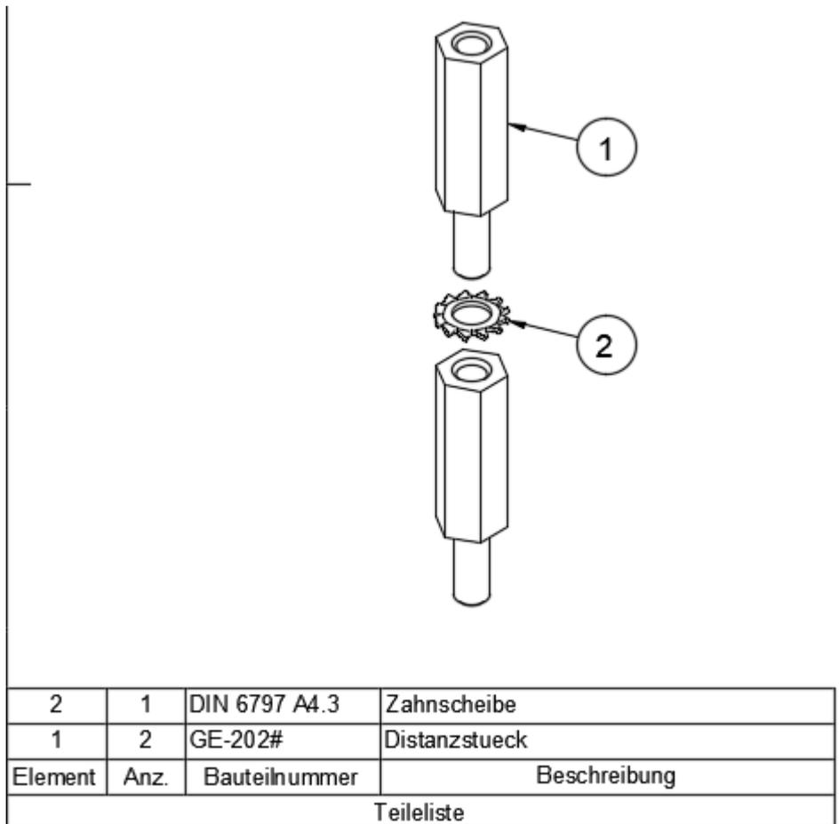
Im Rahmen dieser Einführungsübung konnte damit gezeigt werden, dass es auch für Baugruppen sehr einfach ist, aus einem CAD-Modell die erforderlichen Zeichnungsunterlagen abzuleiten:
