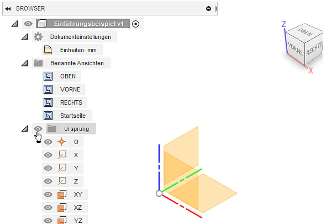
Das **Ursprung-Koordinatensystem** dieser Komponente definiert die Orientierung der Konstruktionsgeometrie im Raum:
