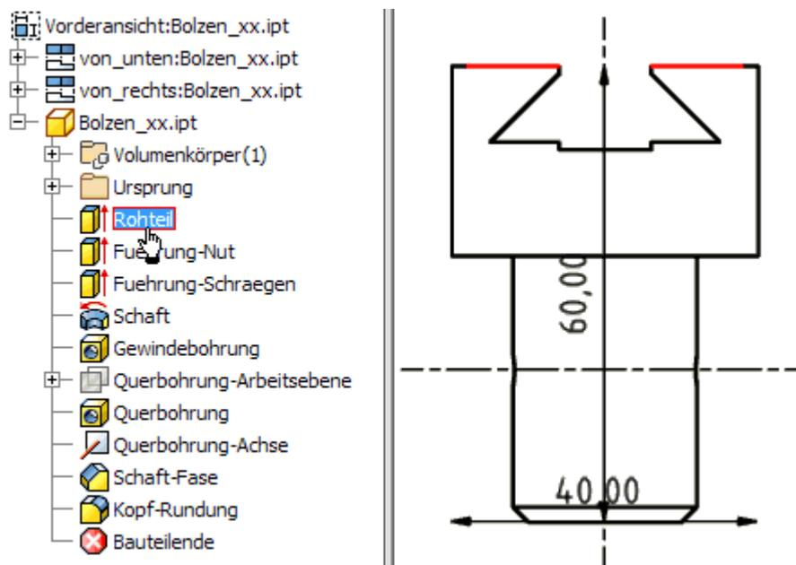
Die Außen-Maße des Rohteils sind nun in der Ansicht sichtbar. Um ihre Wahl mittels OK-Button bestätigen zu können, muss zuvor noch einmal der Button "Bemaßungsquelle auswählen" betätigt werden. Die abgerufene Modell-Bemaßung muss noch im Sinne der Normgerechtheit bearbeitet werden:
