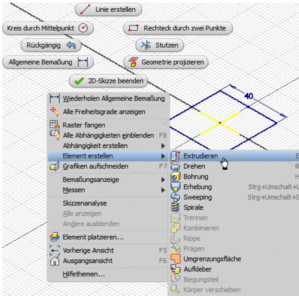
Dabei wird zur besseren Sichtbarkeit der Element-Erzeugung automatisch in eine Isometrieansicht gewechselt. Falls diese als ungünstig erscheint, kann man am **Viewcube** die Ausgangsansicht mit der Z-Achse nach oben wählen:
