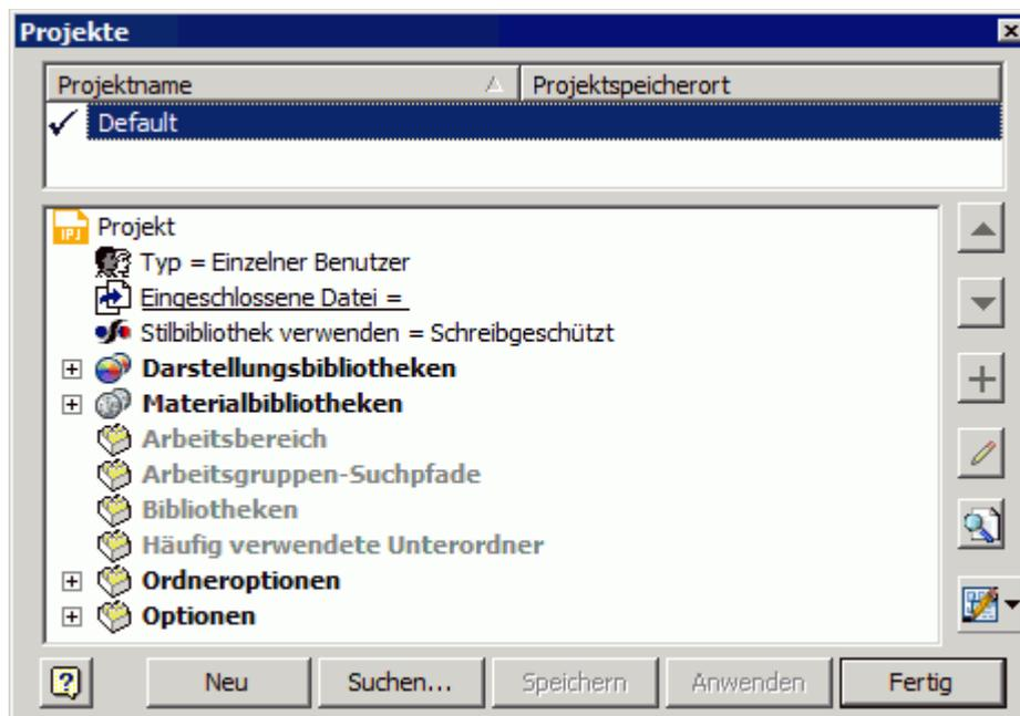
Wir beginnen über *MFL-Neu* mit einer neuen Datei für ein Bauteil (**.ipt=Inventor Part**). Man muss darauf achten, dass die gewählte Standard-Vorlagendatei als Einheit **Millimeter** benutzt. Dies ist bei der deutschen Inventor-Sprachversion im Normalfall standardmäßig eingestellt:
