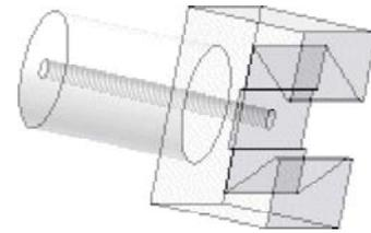
**Platzierte Elemente:** sind vordefinierte Elemente mit vorgegebenen mechanischen Formen. Platzierte Elemente sind beispielsweise Bohrungen, Fasen, Rundungen, Wandstärken, Flächenverjüngungen und Ebenenschnitte. Man muss solche Elemente also nicht individuell als skizzierte Elemente entwickeln, sondern kann die vom CAD-System bereitgestellten konstruktiven Elemente in der Größe anpassen und mit vorhandener Geometrie verknüpfen (Platzieren auf gewünschte Position und in gewünschte Richtung).
