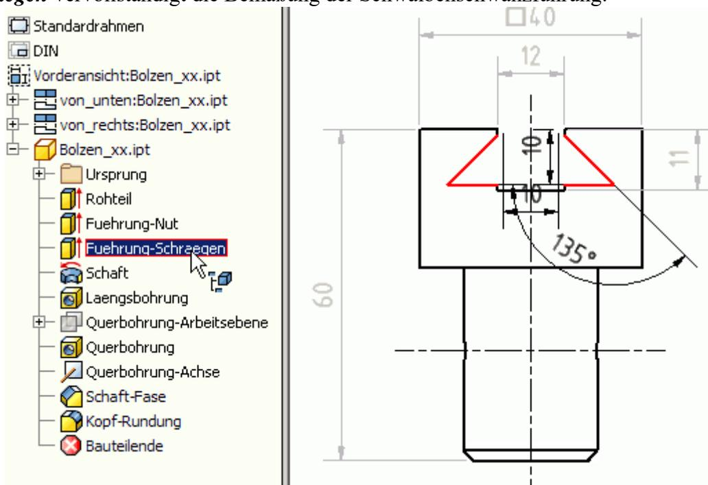
Trotz aller Bemühungen, die Skizzen beim Entwurf des Bauteils fertigungsgerecht zu bemaßen, werden dabei Fehler passieren. Oft bemerkt man solche Unsauberkeiten erst in der bemaßten Zeichnungsansicht, weil dort alle Maße im Zusammenhang angetragen sind.
