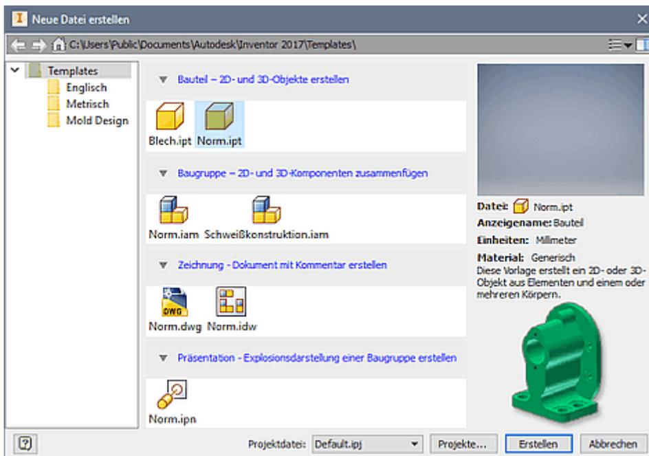
Nach Auswahl der Bauteil-Vorlage gelangt man in die Modell-Umgebung für Bauteile und befindet sich darin im 3D-Modus für die 3D-Modellierung. Man schaut auf die XY-Ebene des Bauteil-Koordinatensystems, auf der man mit der Modellierung des Bauteils beginnen sollte:
