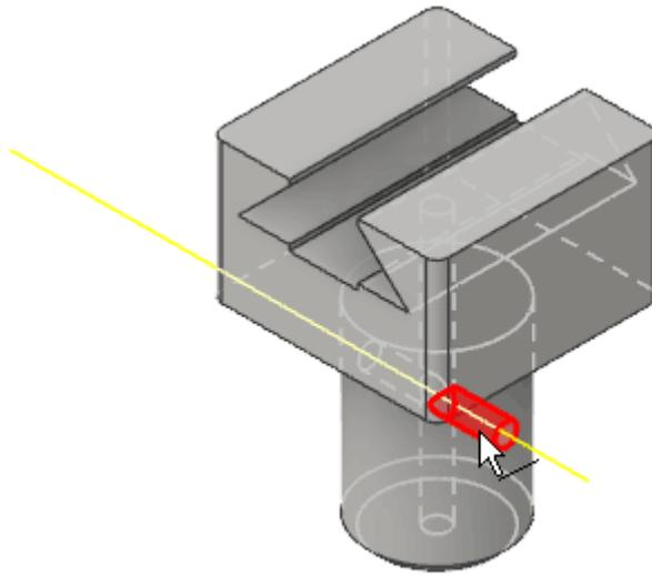
Innerhalb der Baumstruktur des Modells im Browser werden die Elemente in der Reihenfolge ihrer Erzeugung angeordnet. Die nachträglich erzeugte Arbeitsachse für die automatische Mittellinien-Erstellung in der Zeichnung steht deshalb am Ende der Modell-Struktur. Allerdings kann man dieses Element manuell mit dem Cursor bis unmittelbar unter das Querbohrung-Element verschieben:
