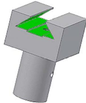
Vom Rohteil (Basiselement) werden bei abtragendem Fertigungsverfahren schrittweise geometrische Elemente (Material-Volumina) entfernt. Man realisiert mittels Material-Abtrag zuerst die funktionell am wichtigsten Elemente.
