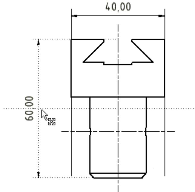
Beim Verschieben der Maßzahl erhält man in Form gepunkteter Linien Hilfestellung (z.B. Zahl in der Mitte der Maßlinie, Maßlinie im vorgegebenen Abstandsraaster).
