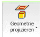
Es ist zwar nicht zwingend erforderlich, aber man sollte Bauteile grundsätzlich fest am Ursprung-Koordinatensystem "verankern"! Mittels des Befehls **Geometrie projizieren** werden die dafür benötigten Achsen bzw. der Mittelpunkt in die Basis-Skizze projiziert. Nur auf projizierte Elemente des Koordinatensystems kann man in der Basis-Skizze Bezug nehmen. Man sollte es sich angewöhnen, immer den Mittelpunkt und die X- und Y-Achse in die Basis-Skizze zu
