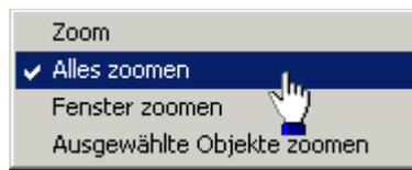
Das Drehen am Laufrad einer Maus führt zu einem schrittweisen Zoomen, welches jedoch die kontinuierliche Zoomfunktion des Zoom-Werkzeuges nicht immer ersetzen kann.
