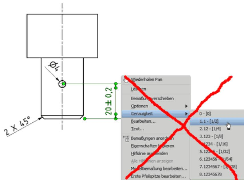
6. Über das Maß-Kontextmenü kann man direkt in der Zeichnung mittels "**Modellbemaßung bearbeiten ...**" sowohl den Nennwert, als auch die zugeordneten Toleranzwerte des Modellparameters ändern. Wir werfen nur einen Blick auf diese Möglichkeit:
