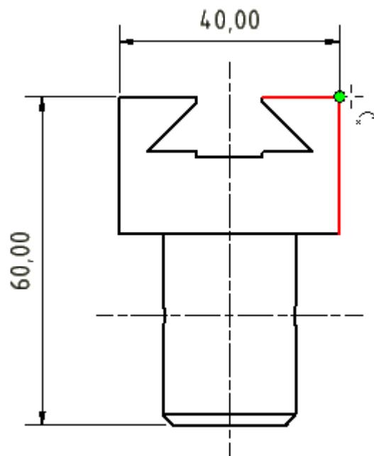
Mit dem Cursor zieht man die Endpunkte der Maßhilfslinien auf die gewünschte Position (meist Eckpunkt einer Körperkante). Der am Koinzidenz-Symbol eingeblendete Marker zeigt, wo die Maßhilfslinie "einrastet".
