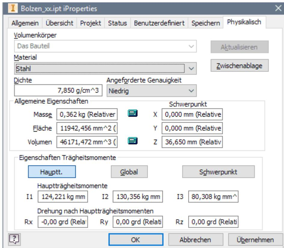
**Hinweis:** Nach einer Modelländerung muss man in diesem Dialogfeld den Button "**Aktualisieren**" betätigen, damit alle Werte ausgehend von den Materialeigenschaften neu berechnet werden. Erst dann erscheint z.B. die aktuelle Masse des Bauteils wieder im Schriftfeld der Zeichnung.
