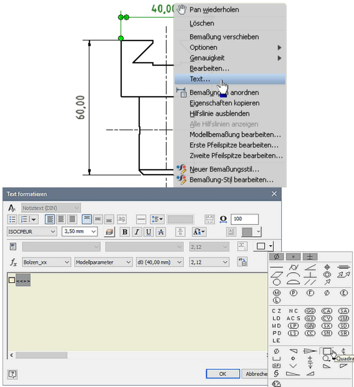
Die Position des Cursors in Bezug auf "<<>>" bestimmt für das eingefügte Symbol die Position und Größe in Bezug auf die Maßzahl.
