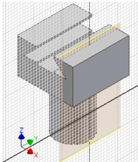
Nach Ausrichten der Ansicht auf die Skizzen-Ebene soll ein Bohrungsmittelpunkt
