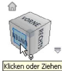
Vor einigen Jahren wurde der von uns bereits genutzte *ViewCube* als neues Werkzeug für die 3D-Navigation eingeführt:
