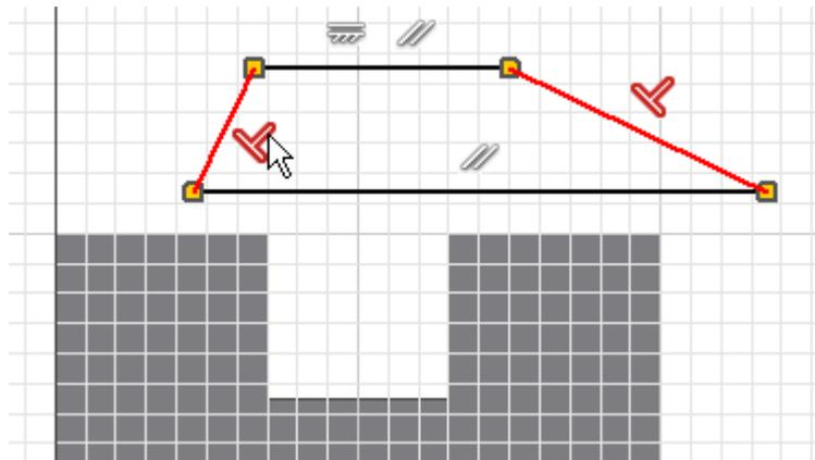
Welche Abhängigkeiten beim Zeichnen des Trapez-Linienzuges automatisch erzeugt wurden, wird sich von Fall zu Fall unterscheiden:
