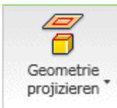
Der Mittelpunkt des Ursprung-Systems wird automatisch in eine neue Skizze projiziert (kleiner gelber Punkt). Damit man ein Bauteil am Koordinatensystem verdrehsicher verankern kann, sollte man grundsätzlich noch die **X-Achse** und die **Y-Achse** in die Basisskizze zu projizieren (falls diese in der XY-Ebene liegt)! Nach Aktivieren von **Geometrie projizieren** muss man diese Ursprungsachsen im Modell-Browser anklicken. Es erscheinen dann die zwei Strecken als unscheinbare Elemente in der
