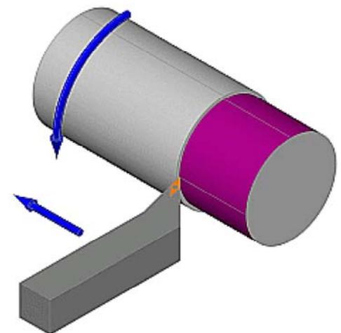
Es gibt keine eindeutige Entscheidung zwischen *Extrusion* und *Drehung*, weil mit der Fläche der Skizze die Summe aller Bahnpunkte der Drehmeißelspitze in einer Ebene abbildet wird. Je nach Betrachtungsrichtung ist dies ein Kreisring oder ein Rechteck.
