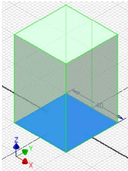
Dann können wir das *Element erstellen* (Rechtsklick > **Überlaufmenü** als Erweiterung des Tortenmenüs) mittels *Extrusion* des Quadrat-Profiles:
