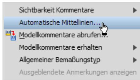
Ein grundlegender Rationalisierungsaspekt moderner CAD-Systeme besteht darin, dass aus dem 3D-CAD-Modell alle benötigten Repräsentationen des Produktmodells "automatisch" abgeleitet werden können. Die bereitgestellten Automatismen sollte man nutzen, auch wenn es auf den ersten Blick häufig einfacher erscheint, z.B. in einer Zeichnungsansicht manuell die benötigten Maße und Mittellinien zu ergänzen!
