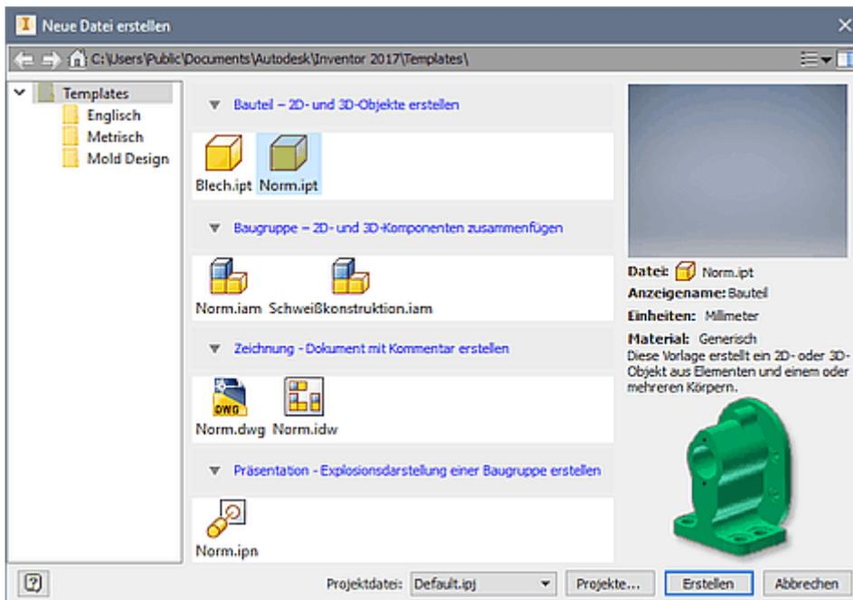
Nach Auswahl der Bauteil-Vorlage gelangt man in die Modell-Umgebung für Bauteile und befindet sich darin im 3D-Modus für die 3D-Modellierung. Die *MFL* ist nun mit einer Vielzahl von Befehlsgruppen versehen:
