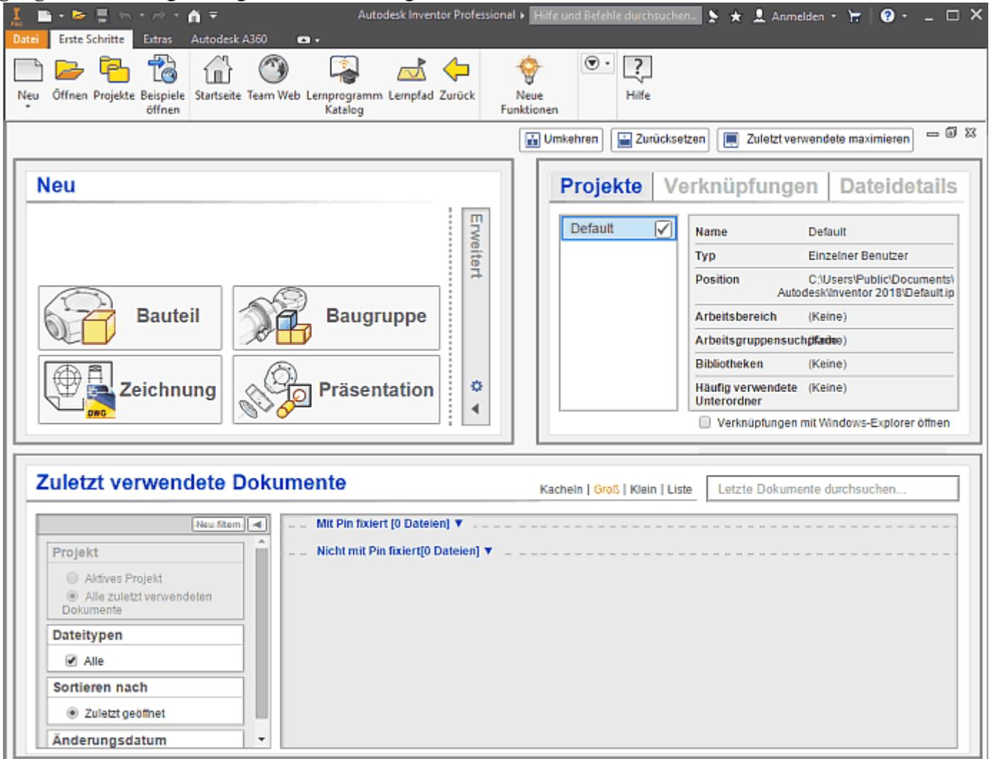
Diese Ausgangsseite schließen wir, um die benötigten Funktionen der Multifunktionsleiste **MFL** zu entnehmen, in welcher nach dem Start die Registerkarte *Erste Schritte* aktiv ist:
