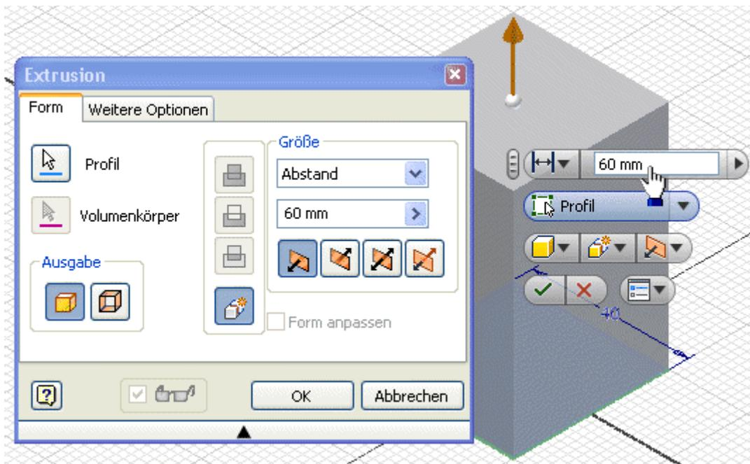
Zusätzlich zum "normalen" **Dialogfeld** werden für einige Befehle **Mini-Werkzeugkästen** zur sogenannten Direktbearbeitung eingeblendet. Wenn man nur mit den Miniwerkzeug-Kästen arbeiten möchte, ist es günstig, die Dialogfelder auszublenden ("Zusammenklappen" über Pfeil). Diese Minimierung der Dialogfelder wirkt nur für Befehle, welche Miniwerkzeug-Kästen besitzen.
