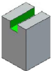
Das Nut-Element kann man auf Basis einer neuen Skizze extrudieren (mit Differenzbildung). Dazu legen wir die erforderliche **Neue Skizze** (Markierungsmenü) auf die Vorderseite des Quaders. Dabei wird automatisch die Ansicht an der Skizzierebene ausgerichtet:
