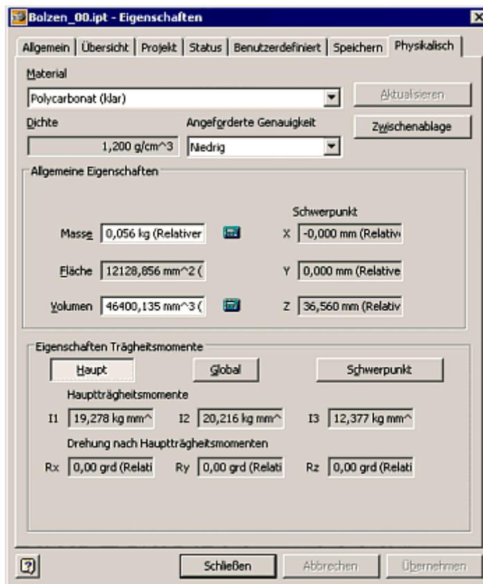
**Hinweis:** Nach einer Modelländerung muss man in diesem Dialogfeld den Button "Aktualisieren" betätigen, damit alle Werte ausgehend von den Materialeigenschaften neu berechnet werden. Erst dann erscheint z.B. die aktuelle Masse des Bauteils wieder im Schriftfeld der Zeichnung.
