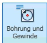
Es fehlt noch die Bemaßung der Gewindebohrung, welche im Inventor als Spezialfall **Bohrung und Gewinde** behandelt wird:
