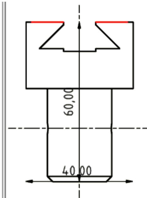
Die Auswahl des Elements zeigt alle für die Ansicht verfügbaren Maße an und man kann sie nach "**Bemaßungsquelle auswählen**" durch Bestätigen mit **OK** übernehmen:
