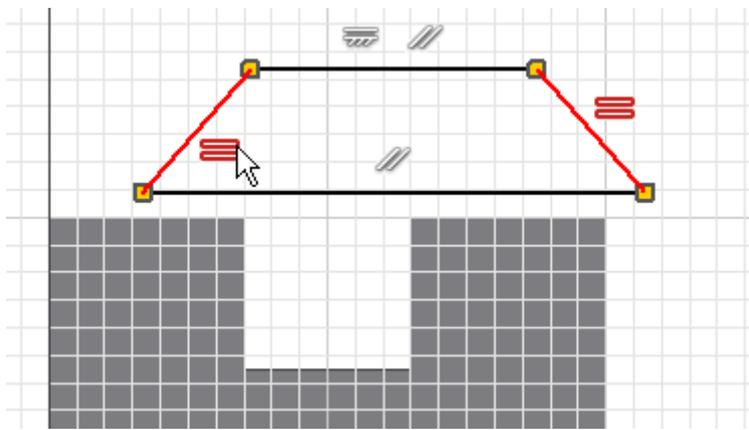
Die Abhängigkeiten blenden wir wieder aus <F9>. Zur Festlegung der Größe muss man nun die **Bemaßung erstellen**. Bei der Bemaßung sollte man wieder fertigungsorientiert bemaßen (z.B. Winkel des Fräsers).
