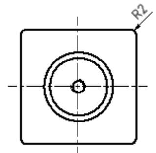
Beim Abruf der Modellbemaßung für Fasen-Elemente erscheinen in Abhängigkeit vom Fasen-Typ die einzelnen Maße meist in unterschiedlichen Zeichnungsansichten. Eine normgerechte Zusammenführung zu einem Fasen-Maß ist nicht möglich. Deshalb sollte man bei Fasen auf die Verwendung von Modellbemaßung verzichten und dafür z.B. die Fasen-Info benutzen, welche im nächsten Abschnitt beschrieben wird.
