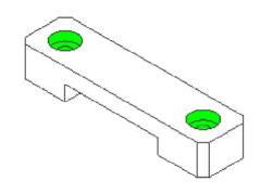
Man kann Bohrungen direkt auf Konturen des Bauteils beziehen (Linear bzw. Konzentrisch). In unserem Fall ist es günstiger, zuvor eine **neue Skizze** zu definieren und darin die erforderlich Bohrmittelpunkte mit den erforderlichen geometrischen Abhängigkeiten zu beschreiben:
