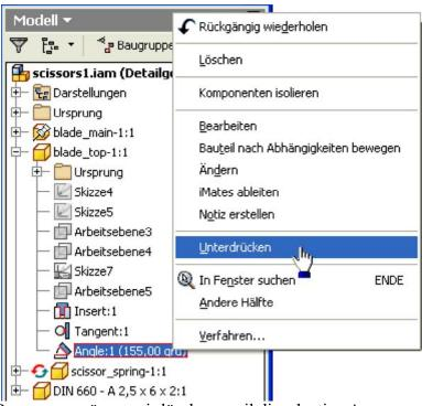
2. Die Feder innerhalb der Baugruppe müssen wir löschen, weil die adaptive Anpassung eines Bauteils (zur Zeit noch) nicht zusammen mit dem manuellen Bewegen von Bauteilen funktioniert. Das "Unterdrücken" der Feder ist leider nicht ausreichend.
