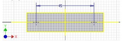
■ Beide Bohrungen sollen später in der Baugruppe Zylinderkopf-Schrauben **DIN 6912 M4x20** aufnehmen. Deren Kopf soll versenkt werden:
