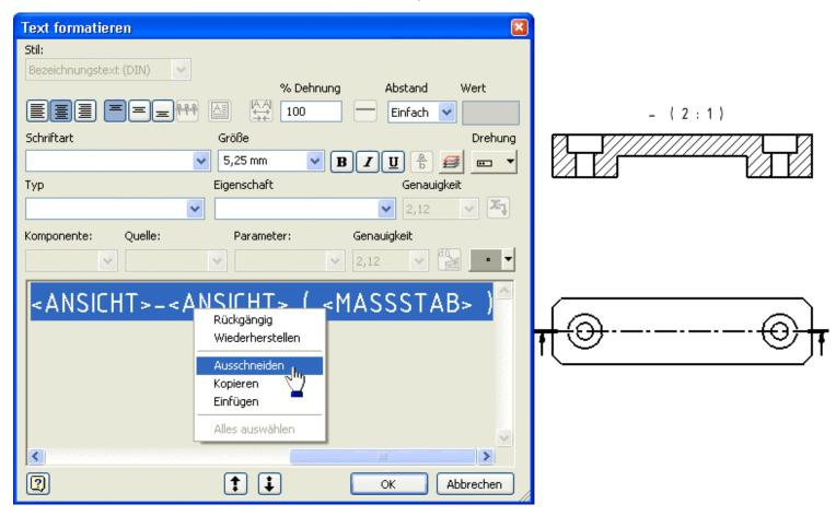
Die Endpunkte der Schnittlinie kann man nachträglich noch so verschieben, dass die dicken Linien-Enden die Körperkanten nur wenig durchdringen.
