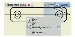
■ Wir können die Standardkonfiguration für Vollschnitte benutzen, sollten aber den Buchstaben A im Ansichtssymbol durch ein Leerzeichen ersetzen. In unserem Beispiel ist der Schnittverlauf eindeutig zuzuordnen und muss nicht durch zusätzliche Beschriftungen "belastet" werden:
