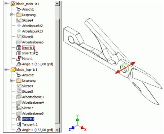
■ Um ein geeignetes Verbindungselement auszuwählen, benötigen wir die Abmessungen der Lagerbohrung. Mittels *Prüfen > Abstand* messen ist die Ermittlung des Lochdurchmessers einfach (falls 3,1 mm angezeigt werden, misst man den Fasenrand!):
