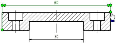
Nach dem Positionieren der Bemaßung ergänzen wir für das Fasen-Maß noch den Fasenwinkel von 45° als Text:
