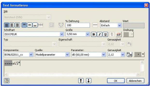
• *Hinweis:* Der Text **45°** passt sich nicht an eine Änderung des Fasenwinkels im Modell an! Solch einen Trick darf man nur anwenden, wenn man genau weiß, dass sich der Fasenwinkel für dieses Bauteil nie ändert!
