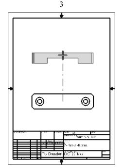
Das Schriftfeld wurde nach dem Platzieren der Erstansicht automatisch mit Informationen aus dem Bauteil belegt:
