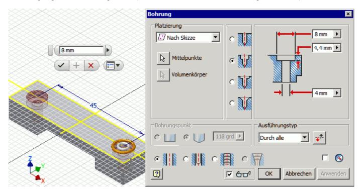
• Die Bohrungen kann man nachträglich mittels Element bearbeiten jederzeit umkonfigurieren (Kontextmenü des Elements im Modellbrowser):
