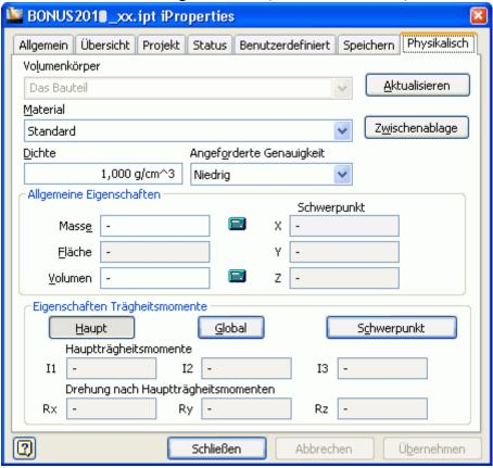
Wir wählen Aluminium - 6061 als Material. In Abhängigkeit von der Inventor-Version unterscheiden sich die Material-Parameter ein wenig. Es erfolgt automatisch eine Berechnung der abhängigen physikalischen Eigenschaften mit der angeforderten Genauigkeit (Default=niedrig):
