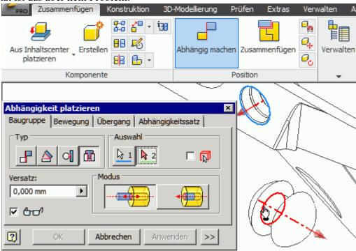
Die Lage der Bauteile zueinander wird über Zusammenbau-Abhängigkeiten festgelegt. Insbesondere für rotationssymmetrische Bauteile (z.B. unser Niet) ist das Einfügen | fin eine sehr intuitive Montage-Möglichkeit. Man wählt einfach von den Flächen, welche nach der Montage aufeinander liegen sollen, die zugehörigen Kreiskanten (Siehe vorheriges Bild). Dabei muss man nur beachten, dass man z.B. bei der Fase am Lochrand die äußere Kreiskante trifft!
