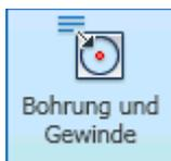
Für Bohrungen besteht die Möglichkeit, sogenannte **Bohrungs-/Gewindeinfo** zu verwenden. In Form einer vereinfachten Bemaßung erscheinen dann sämtliche Angaben zur Bohrungskonfiguration. Die Darstellung ist jedoch nicht ganz normgerecht. Mit etwas Editier-Aufwand kann man die Beschriftung normgerecht gestalten (DIN 6780 oder [1] S.4.6 unten).
