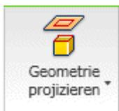
Damit man ein Bauteil am Koordinatensystem verankern kann, sollte man grundsätzlich **Mittelpunkt**, **X-Achse** und **Y-Achse** in die Basisskizze zu projizieren! Nach Aktivieren von **Geometrie projizieren** muss man diese Elemente im Modell-Browser anklicken. Es erscheinen dann der Punkt und zwei Strecken als unscheinbare Elemente in der Skizze:
