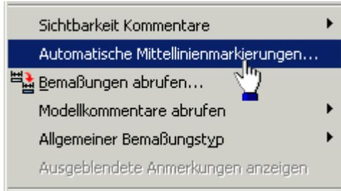
Ein grundlegender Rationalisierungsaspekt moderner CAD-Systeme besteht darin, dass aus dem 3D-CAD-Modell alle benötigten Repräsentationen des Produktmodells "automatisch" abgeleitet werden können. Die bereitgestellten Automatismen sollte man nutzen, auch wenn es auf den ersten Blick häufig einfacher erscheint, z.B. in einer Zeichnungsansicht manuell die benötigten Mittellinien und Maße zu ergänzen!
