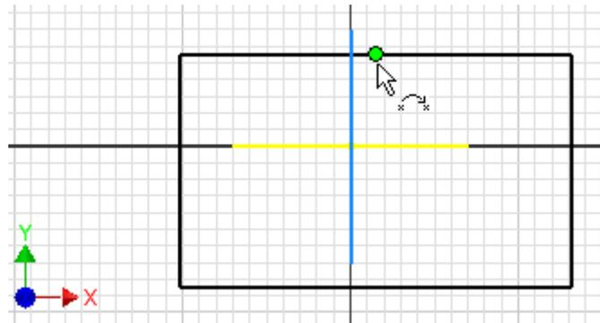
Die Abhängigkeiten der Skizzenelemente kann man mittels der Taste **F8** als Symbole einblenden (und mit **F9** wieder ausblenden):
