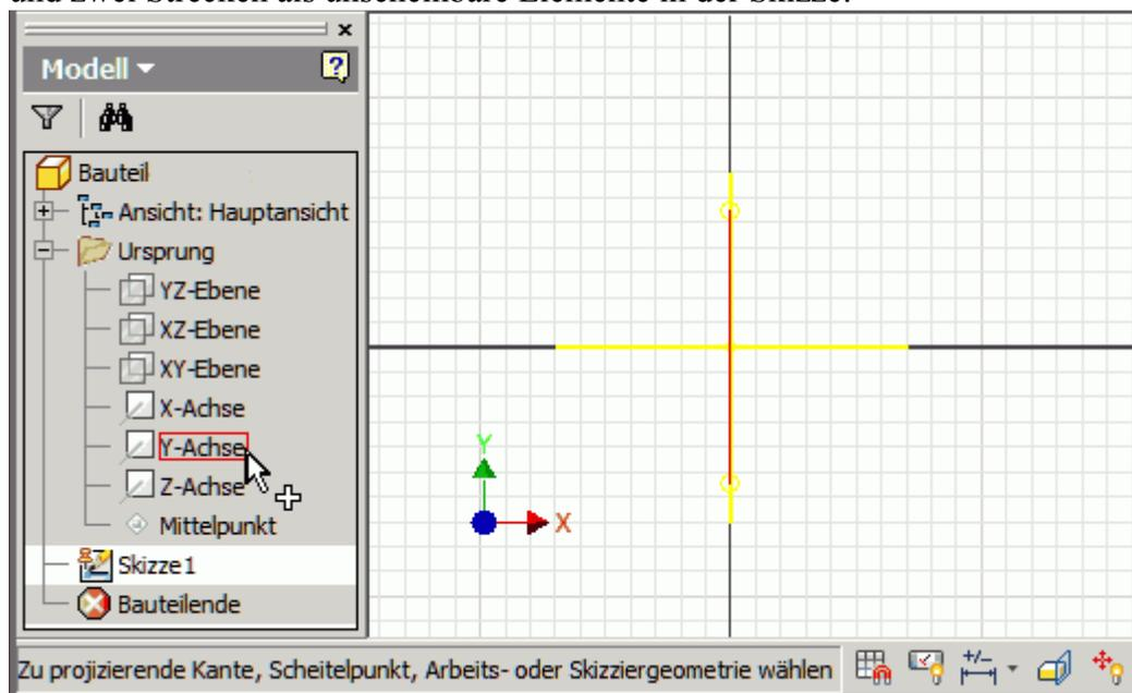
**Hinweis:** Befehle beendet man mittels **ESC**-Taste, über das Kontext-/Markierungsmenü (rechte Maustaste) oder durch Aufruf des nächsten Befehls.
