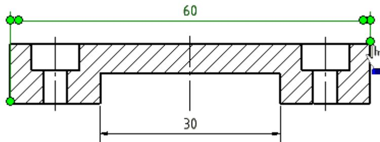
Nach dem Positionieren der Bemaßung ergänzen wir für das Fasen-Maß noch den Fasenwinkel von  $45^\circ$  als Text:
