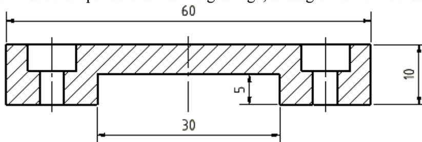
Im Beispiel ist es uns gelungen, fast alle Maße in Form von Modellbemaßung abzurufen. Nur die Bemaßung der beiden Bohrungen ist noch unvollständig:
