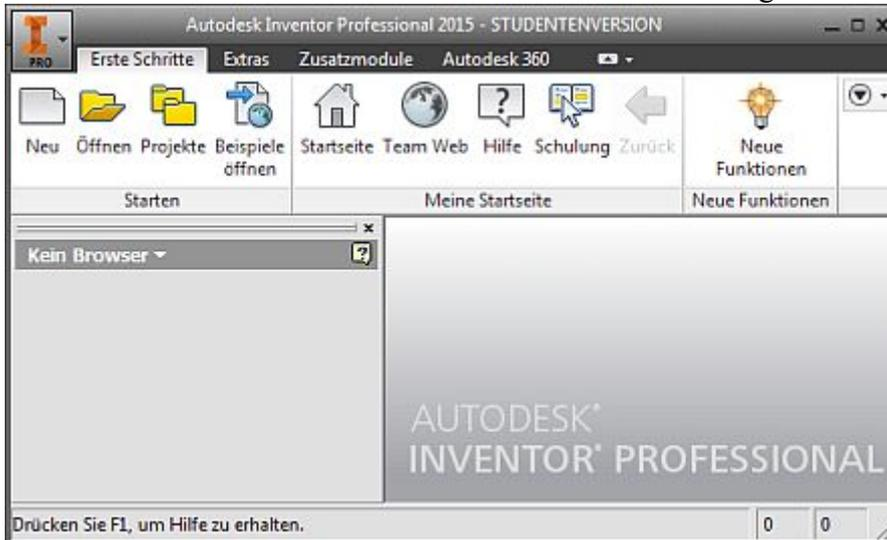
Jegliche Arbeit im CAD-System erfolgt im Rahmen eines Projektes. Der Aufruf von **Projekte** in der *MFL* führt zu einer Übersicht der vorhandenen Projekte. In dieser einführenden Übung sollten wir darauf achten, dass *Default* als Projektname ausgewählt und aktiv ist. Das damit definierte Standard-Projekt verwaltet die CAD-Dateien im Ordner "**Dokumente\Inventor**":
