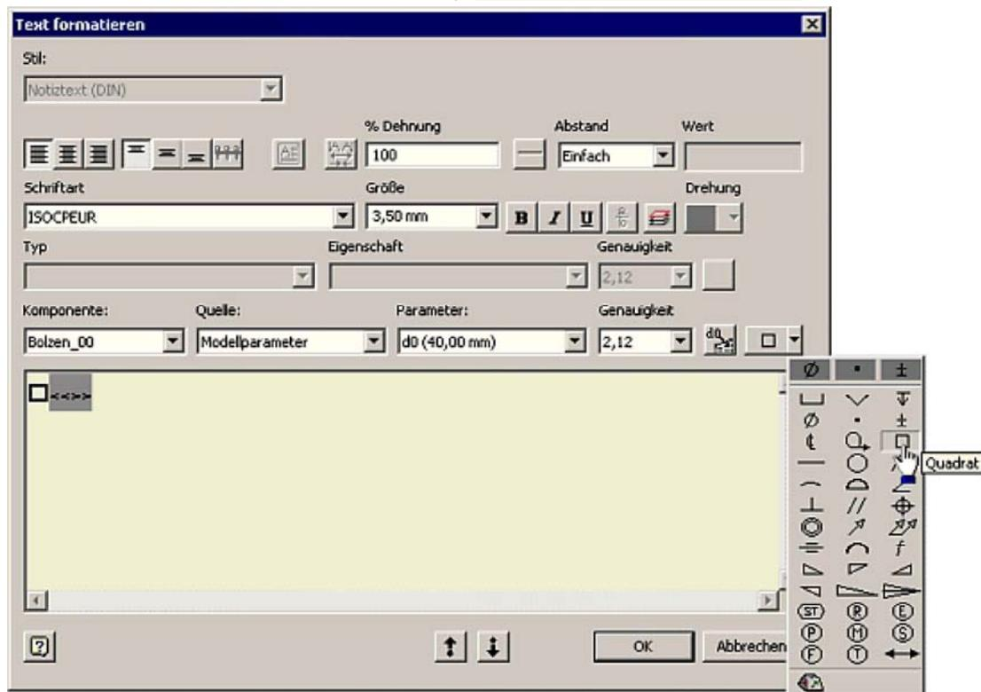
Die Position des Cursors in Bezug auf "<<>>" bestimmt für das eingefügte Symbol die Position und Größe in Bezug auf die Maßzahl.
