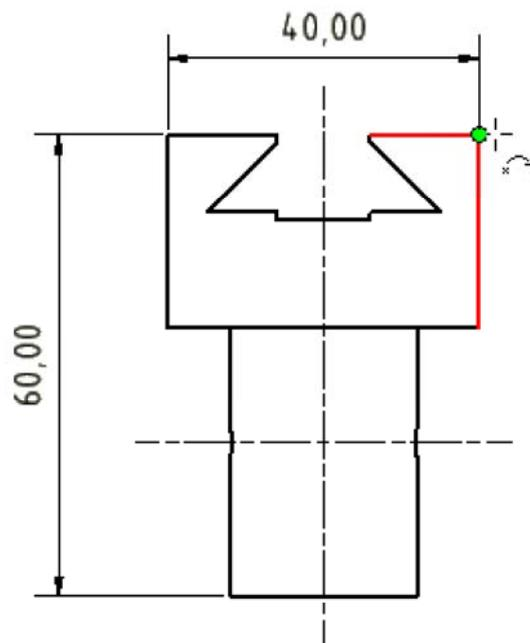
Mit dem Cursor zieht man die Endpunkte der Maßhilfslinien auf die gewünschte Position (meist Eckpunkt einer Körperkante). Der am Koinzidenz-Symbol eingblendete Marker zeigt, wo die Maßhilfslinie "einrastet".
