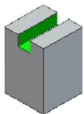
Das Nut-Element kann man auf Basis einer neuen Skizze extrudieren (mit Differenzbildung). Dazu legen wir die erforderliche *Neue Skizze* (Markierungsmenü) auf die Vorderseite des Quaders. Dabei wird automatisch die Ansicht an der Skizzierebene ausgerichtet:
