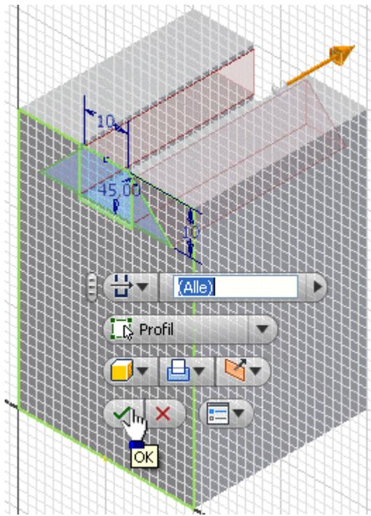
Die Profilskizzen für die Erzeugung skizzierter Elemente sollten geometrisch möglichst einfache Grundformen darstellen (z.B. Kreis, Dreieck, Viereck). Das ergibt sich "automatisch", wenn man sich hierbei an den erforderlichen Fertigungsschritten für das Bauteil orientiert.
