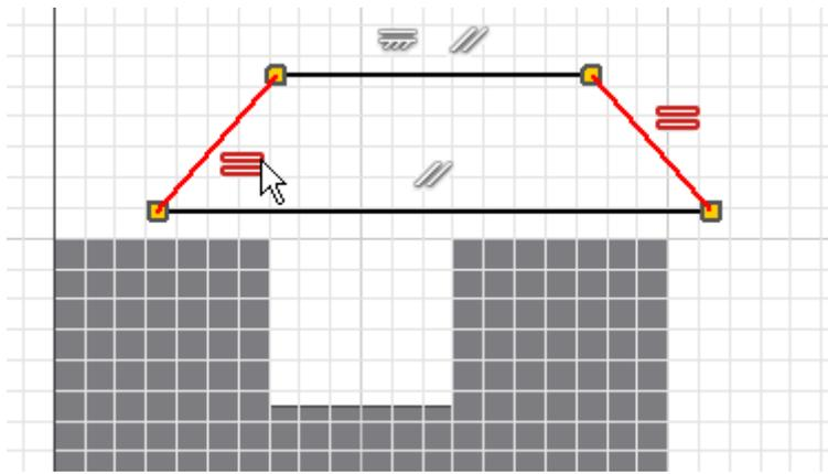
Die Abhängigkeiten blenden wir wieder aus <F9>. Zur Festlegung der Größe muss man nun die **Bemaßung erstellen**. Bei der Bemaßung sollte man wieder fertigungsorientiert bemaßen (z.B. Winkel des Fräasers).
