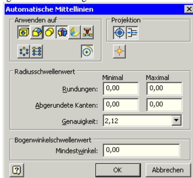
Die "Ausbeute" an automatisch erzeugten Mittellinien ist in allen Ansichten mager. Es erscheinen nur die Mittellinien der "Drehung" für den Bolzenschaft. Wir machen die automatische Erzeugung der Mittellinien in allen Ansichten wieder rückgängig (mehrmaliges <Strg>+<Z>).
