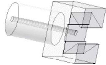
**Platzierte Elemente:** sind vordefinierte Elemente mit vorgegebenen mechanischen Formen. Platzierte Elemente sind beispielsweise Bohrungen, Fasen, Rundungen, Wandstärken, Flächenverjüngungen und Ebenenschnitte. Man muss solche Elemente also nicht individuell als skizzierte Elemente entwickeln, sondern kann die vom CAD-System bereitgestellten konstruktiven Elemente in der Größe anpassen und mit vorhandener Geometrie verknüpfen (Platzieren auf gewünschte Position und in gewünschte Richtung).
