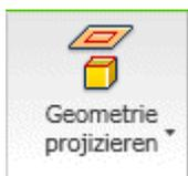
Es ist zwar nicht zwingend erforderlich, aber man sollte Bauteile grundsätzlich fest am Ursprung-Koordinatensystem "verankern"! Mittels des Befehls **Geometrie projizieren** werden die dafür benötigten Achsen bzw. der Mittelpunkt in die Basis-Skizze projiziert. Nur auf projizierte Elemente des Koordinatensystems kann man in der Basis-Skizze Bezug nehmen. Man sollte es sich angewöhnen, immer den Mittelpunkt und die X- und Y-Achse in die Basis-Skizze zu projizieren!
