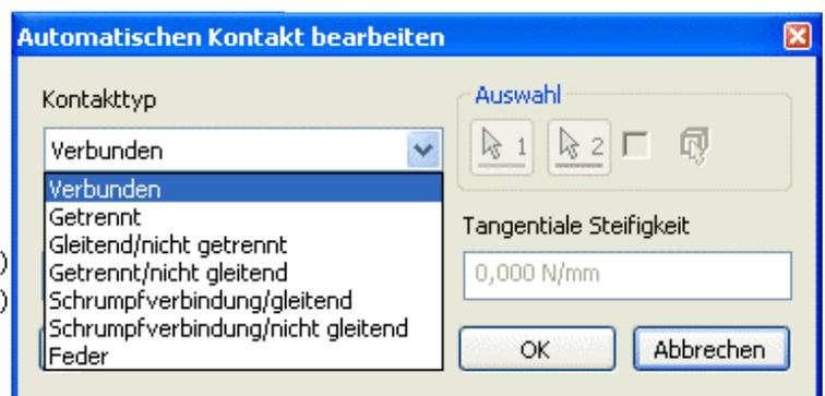
Bis auf den Feder-Kontakt erhält man bei allen Kontakt-Paarungen keinen Zugriff auf Kontakt-Parameter. Beim Feder-Kontakt kann man Steifigkeiten senkrecht und tangential zur Kontaktstelle angeben.
