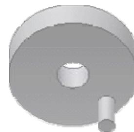
Das Reibrad wird aus einer mehrfach verwendeten Skizze einschließlich des Lagers durch Extrusionen generieren. Das große Reibrad hat die folgenden Abmessungen:
